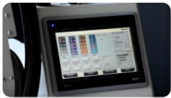
Laser parameter controlling via touch screen
